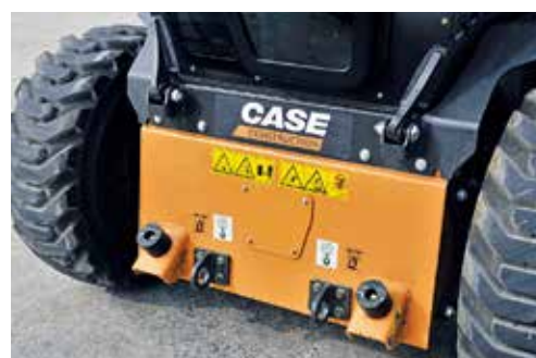
Direkte Abstützpunkte am Fahrwerksrahmen unterstützen die Schubleistung
